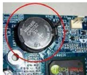
**Figura 1.** Batería de Mainboard
